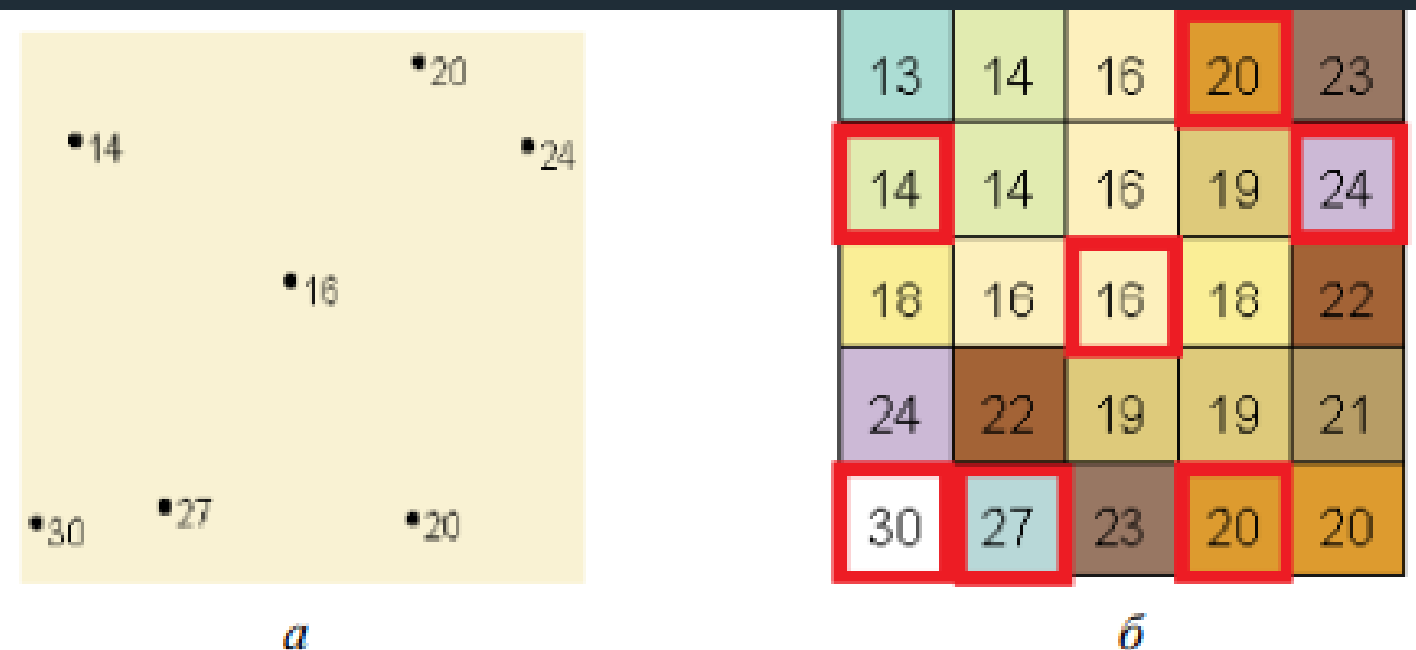
Рис. 2.1. Пример создания интерполяционной грид-модели (б) по точечной теме (а) [16]
